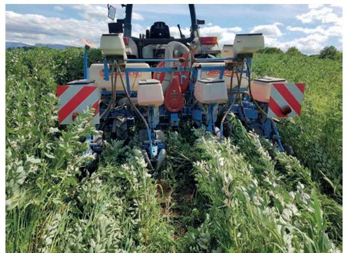
Semi irrégulier dû au semoir non modifié
