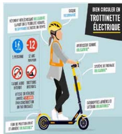
orange visibles de côté ; il s'agit d'un système réfléchissant la lumière et servant à signaler le véhicule aux autres usagers de la route. Ces dispositifs réfléchissants latéraux ne sont cependant pas obligatoires si les roues de votre véhicule en sont déjà équipées.
